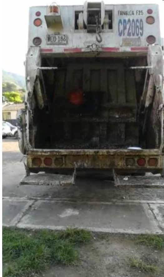
Fotografía 8. Compactación de residuos sólidos que no presenta fuga
